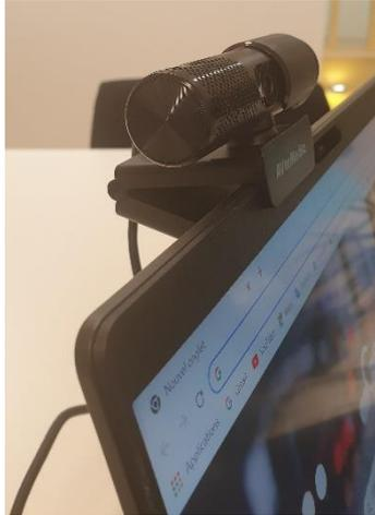
2. Brancher la webcam à l'ordinateur sur le port USB-A et glisser le cache de la lentille sur la droite.
